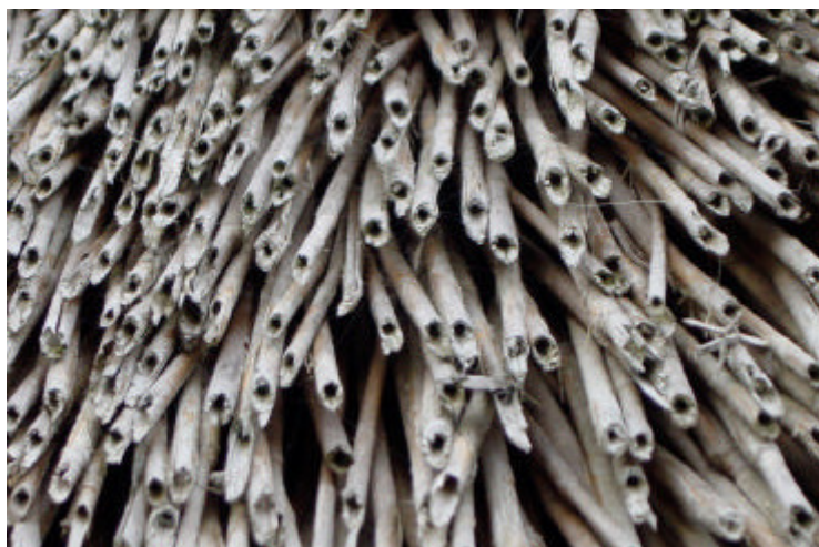
Foto 17: Miscanthusrørs tilstand efter 19 måneder i Wennekingstedt på Sylt.
