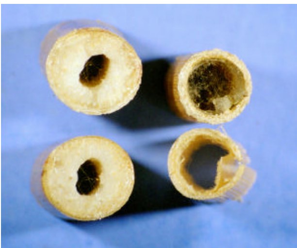
Foto nr. 34: tværsnit af miscanthusrør (til venstre) og tagrør (til højre)
