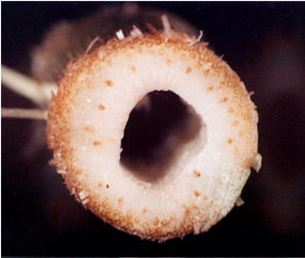
Foto nr. 35: hulrum, marvstruktur og cellevæg med vaskulære karstrengene på et miscanthusrør.
