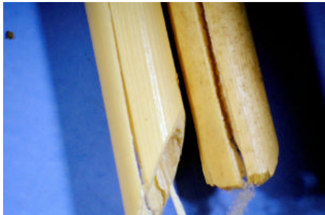
Foto nr. 24: Revnedannelse ved afskæring danner grobund for svampeangreb. (til venstre tagrør; til højre miscanthus)
