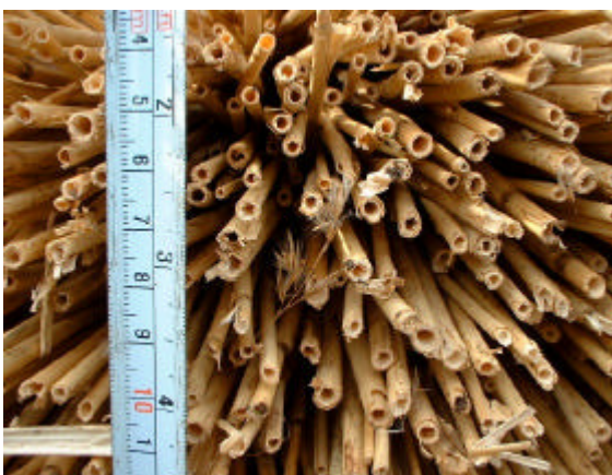
Foto 9: Tagrørs mindre diameter og mindre vægtykkelse, et mere jævnt snit.
