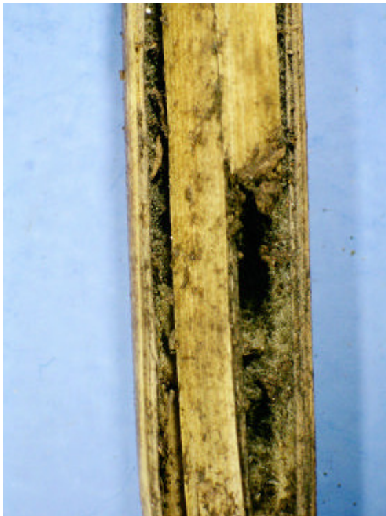
Foto nr. 25: Koloni af svampe og bakterier på en beskadiget miscanthus-rodende 1 år efter tagets færdiggørelse.
