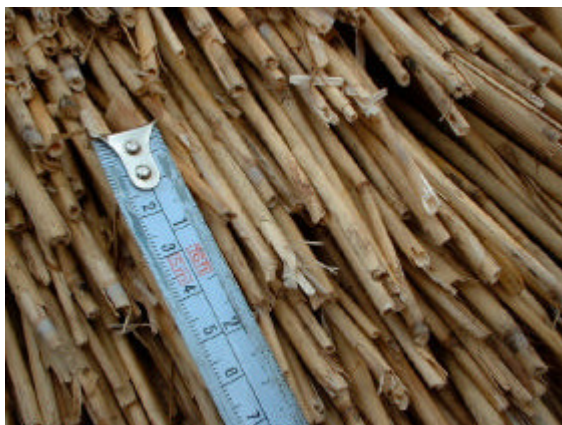
Foto 8: Tagrør har næsten ingen brud og udmerker sig ved færre spaltninger.
