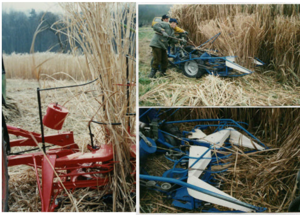
Figur 46: Selvbinders: bugseret redskab( Agostini) til traktor (til venstre), BCS 1-akslet selvbinder. Skæret er forsynet med fangarme, som fører de snittede rør ind til midten af skæret og videre til bindeanordningen.
