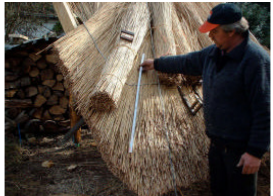
Foto 4: Længden af de synlige miscanthusrør ved gavlafslutning.
