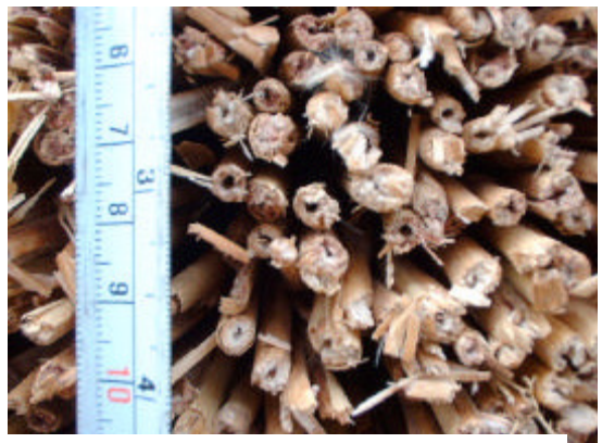
Foto 10: Miscanthus: større diameter, Større vægtykkelse, delvis spaltning ved snittet.
