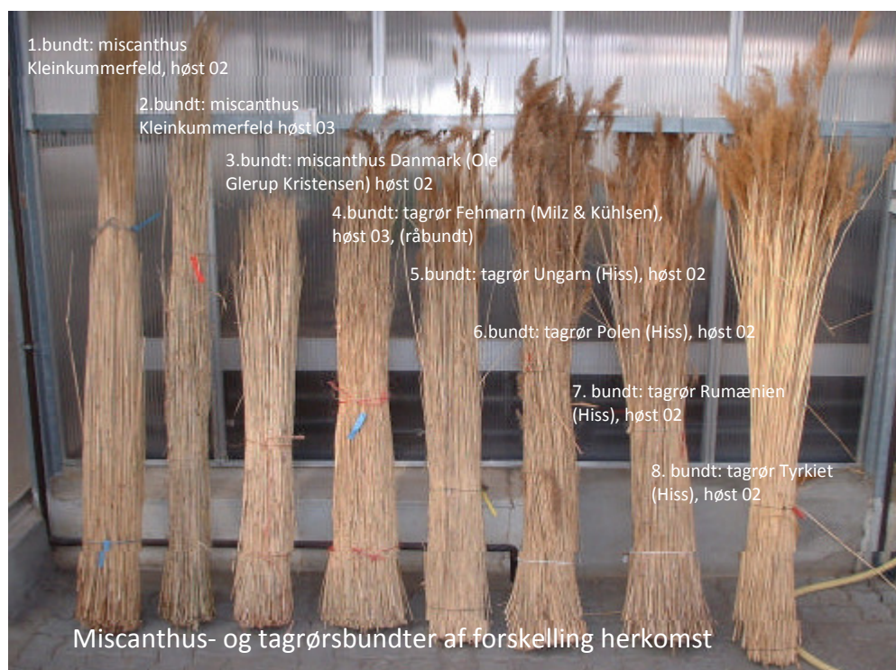
Foto 19: Miscanthus og tagrørsmateriale til undersøgelse af bøjningskraft
