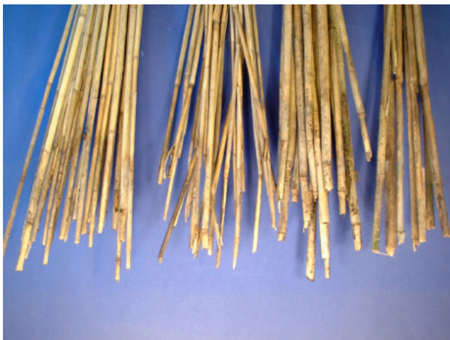
Foto nr. 40: Rodender fra tagrør (oprindelse fra venstre: Fehmarn, Ungarn, Polen) og miscanthus (til højre) efter 6 måneder i muldagtig tørvkultursubstrat.
