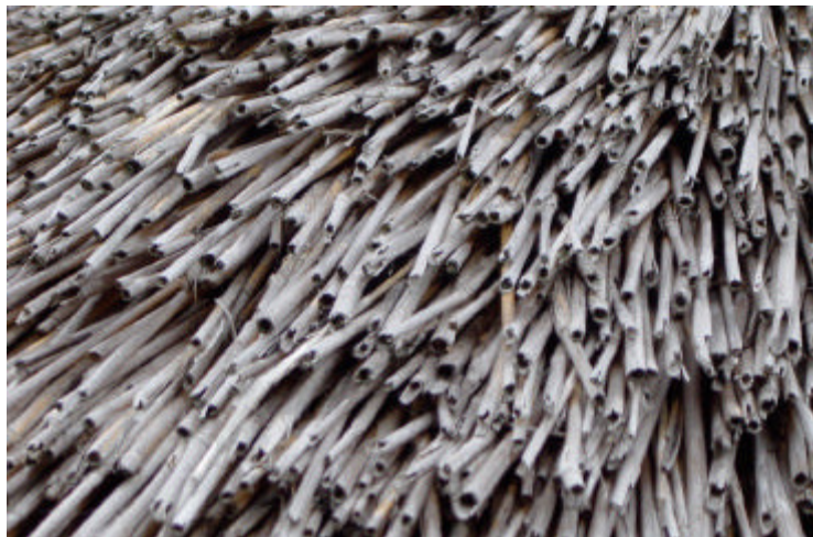
Foto 16: Tagrørs tilstand efter 19 måneder i Wennekingstedt på Sylt.
