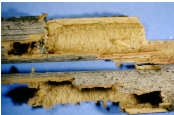
Foto nr. 26: Rodende på Miscanthusrør efter 16 års vejrpåvirkning. Jylland, Danmark
