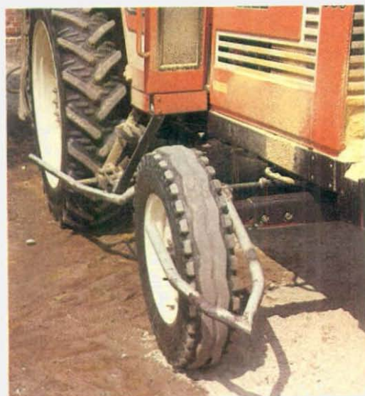
Stråskillere monteret på en traktor til sprøjtning i høje afgrøder. Ved sen sprøjtning i korn kan stråskillere formindske nedkørsel af strå og medvirke til færre grønskud.
