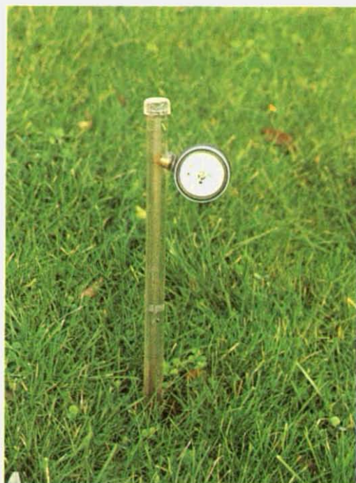
Tensiometer til måling af jordens udtøringsgrad og bestemmelse af vandingstidspunktet. For at opnå god kontakt med jorden skal der ved placeringen anvendes et bor af samme dimension som tensiometerets føler.
