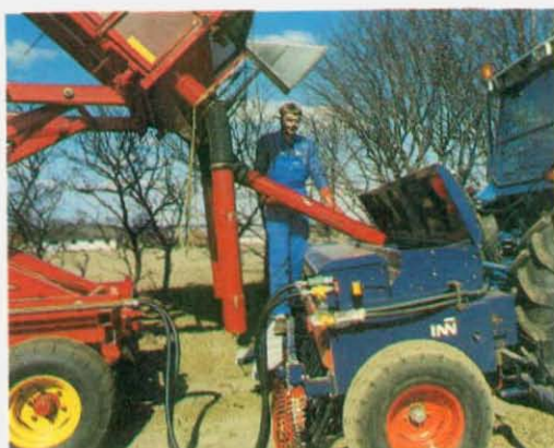
Kombisåmaskinen påfyldes gødning fra højtivogn. De arbejdsmæssige ulemper ved anvendelse af kombisåmaskine kan mindskes, hvis man råder over den rette mekanik.
