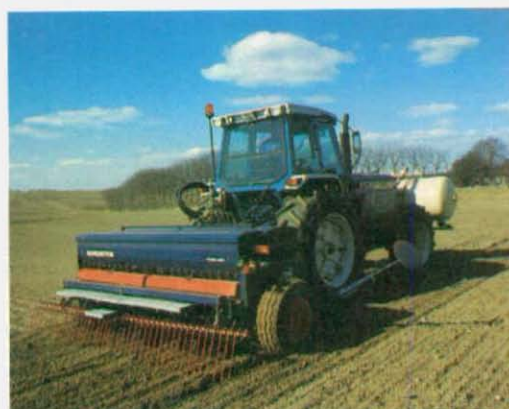
Kombineret udsåning af korn og placering af såvel PK-gødning som ammoniak.
