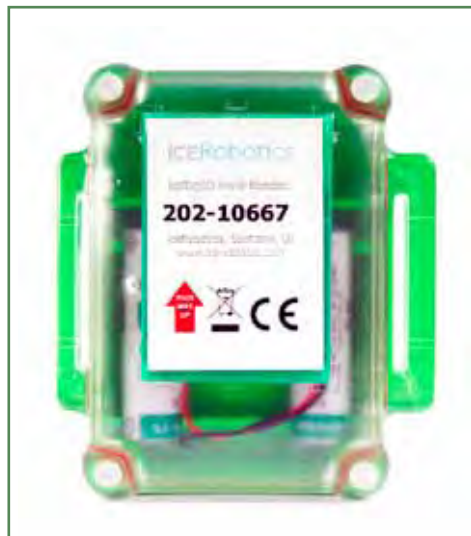
Figur 2. Sensoren måler 95mm x 85mm x 31,5mm og vejer ca. 170 g.
