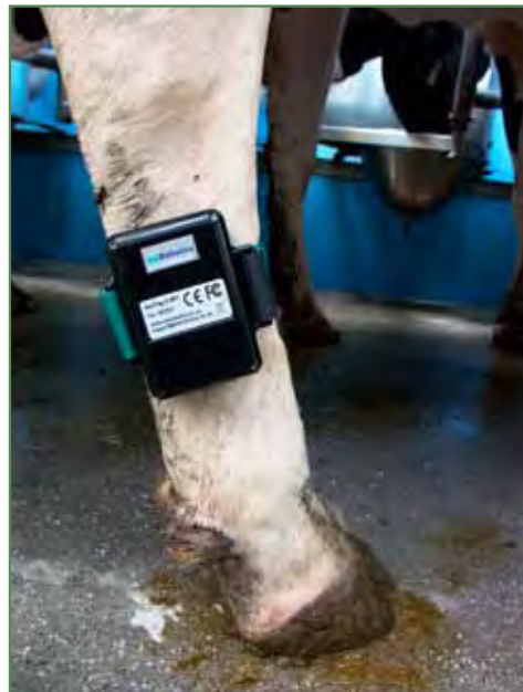
Figur 1. I projekt SundKlov anvendes en ny type sensor til automatisk registrering af ligge- ståadfærd og aktivitet.
