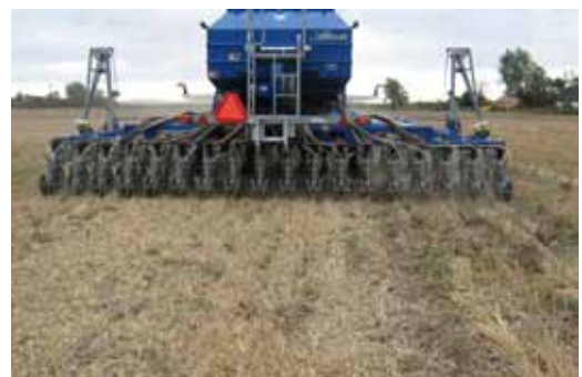
En såmaskine, specielt udviklet til direkte såning, er anvendt i et af forsøgsleddene. Her sår såmaskinen under meget tørre forhold på Syd-Sjælland i efteråret 2009. (Foto: Henry Møller Andersen, Østdansk LandbrugsRådgivning).
