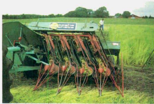
Her ses ruskeaggregatet på en hørrusker. Spydene fordeler planterne, som indføres, trækkes op med rod, og med roterende gummibånd føres op på den aflæggeplade, der vender stråene vinkelret på køreretningen.
