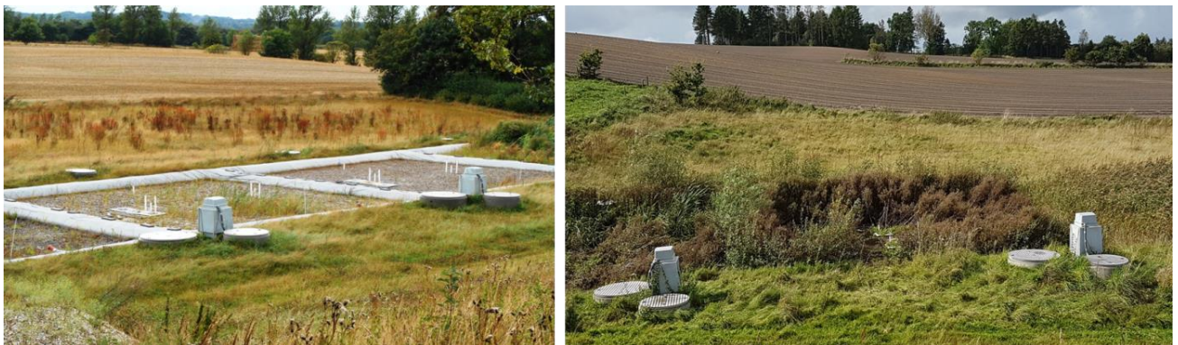
Figur 16. Forsøgsanlæg med filtermatricer etableret i 2012 før og efter etablering af vådbundsvegetation. Brønde og kasser er måleudstyr der blev anvendt i forbindelse med forskningsprojektet.
