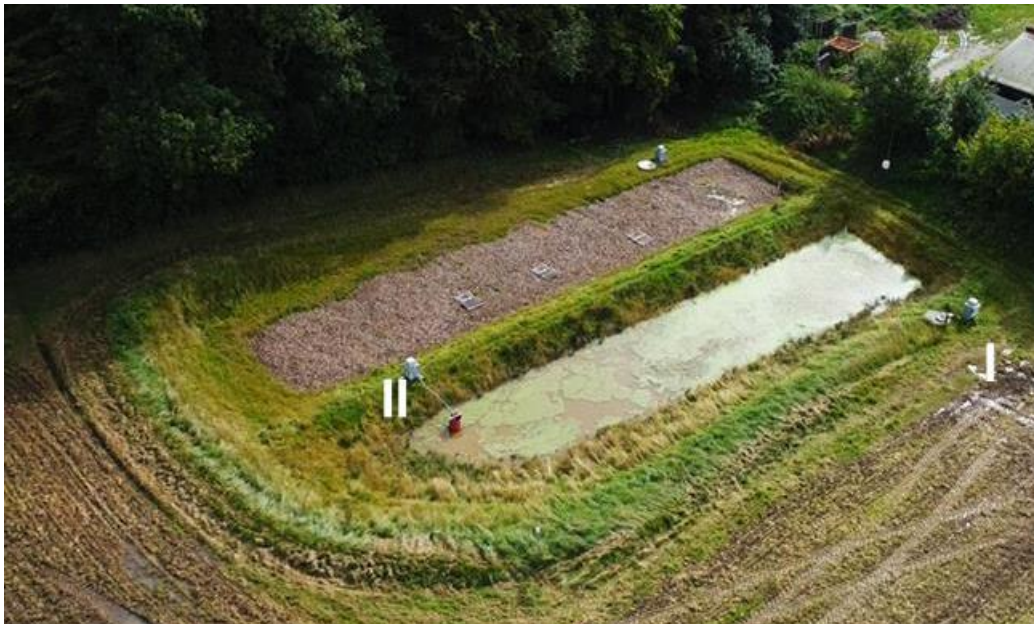
Figur 2. Placering af omløbsdrænet før sedimentations/stuvningsbassin (I) eller mellem sedimentations/stuvningsbassin og filtermatrice (II).
