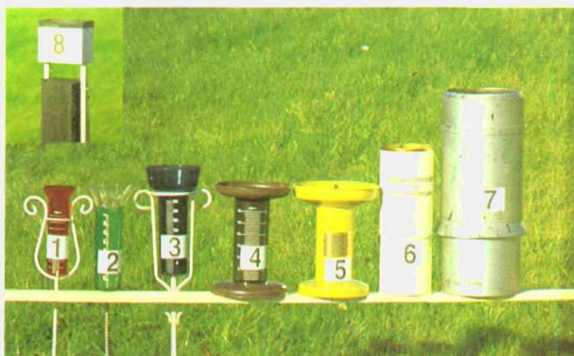
Figur 6. Nedbørmålere som afprøves på Forsøgsgården Godthab i Skanderborg.
