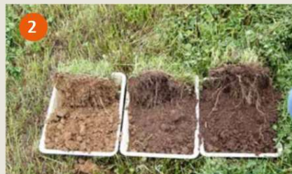
2 Vurder jordens lugt, farve, aggregater og fasthed ved hjælp af skemaet til højre.
