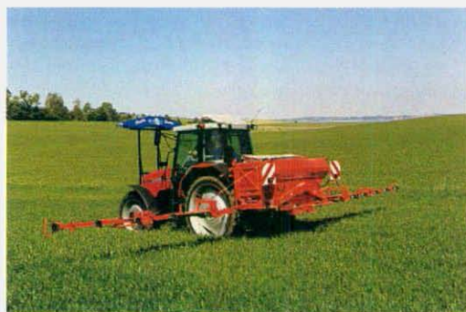
Traktor med gødningsspreder og N-Sensor monteret på bommen foran førerhuset.
