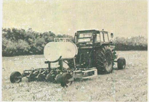
3,30 m bugseret punktnedfælder (prototype) til flydende ammoniak, udviklet af Superfos. Nedfældertypen har med de rullende nedfælderaggregater et lille trækraftbehov.
